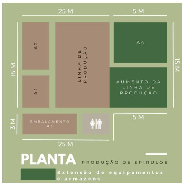
**Figura D.1:** Proposta de planta para a linha de produção de Spirulos e possível extensão de equipamentos e armazéns.
